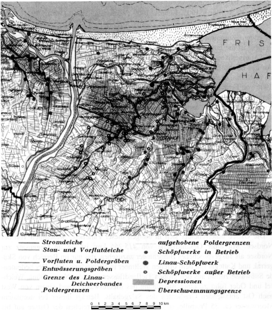
Abb. 5 : Deiche und Entwässerungsanlagen im Weichsel-Nogat- Delta. (Creutzburg 1936)
